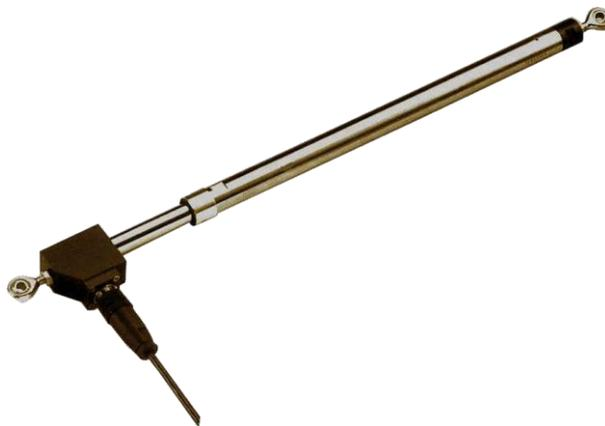
Les capteurs de la famille CER sont des capteurs robustes, associant un LVDT type SX12K Sécurité Intrinsèque (SI) à un guidage sur palier lisse avec joint racler.
