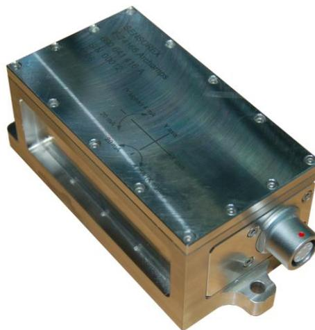
Le servo-inclinomètre 2 axes immergeable (si) est basé sur le servo-inclinomètre type SX41200, dont il possède les performances.
