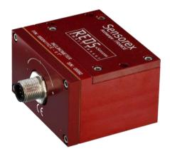
L'inclinomètre modèle SX41100 est un capteur angulaire asservi à détection optique infrarouge. L'élément sensible est un mouvement de galvanomètre balourdé, sans frottement, flotté dans un fluide d'amortissement visqueux.
