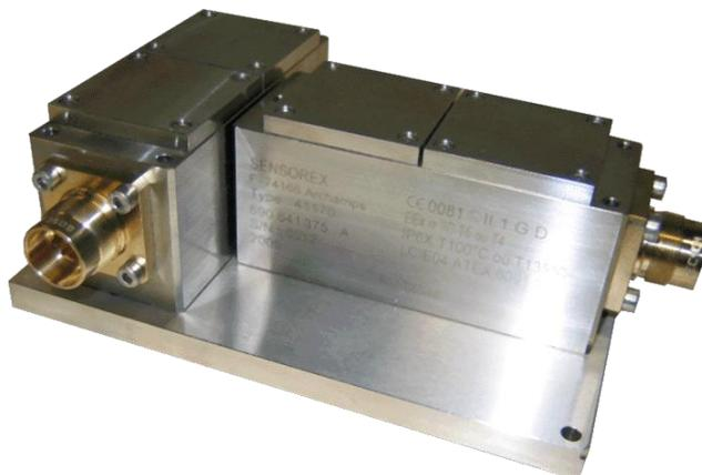
Le servo-inclinomètre 2 axes immergeable (SI) sur platine est composé de deux servo-inclinomètres mono axe type SX41170 (SI), montés perpendiculairement sur une plaque.
