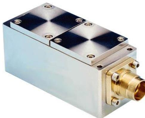
Le servo-inclinomètre modèle SX41170 (SI) est un capteur d'inclinaison mono-axe à alimentation continue et sortie proportionnelle au sinus de l'angle d'inclinaison.
